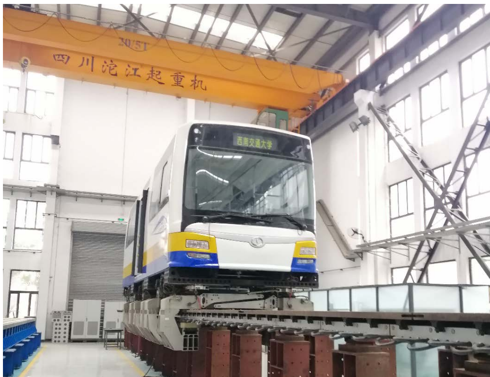
ภาพที่ 9 รถไฟแม่เหล็กและทางวิ่งต้นแบบสำหรับงานวิจัยในห้องปฏิบัติการ
