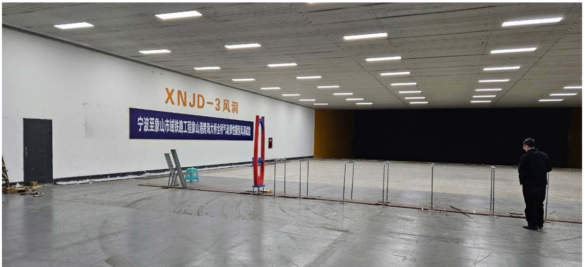
ภาพที่ 11 ช่วงทดสอบของอุโมงค์ลม เปรียบเทียบกับคนและแบบจำลองสะพาน แวนซึ่งกำลังก่อสร้าง
