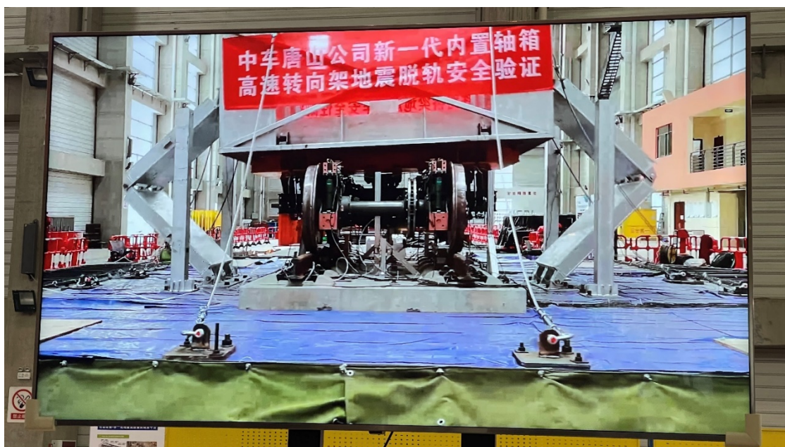
ภาพที่ 8 การทดสอบแผ่นดินไหวของระบบรางและโบกี้
