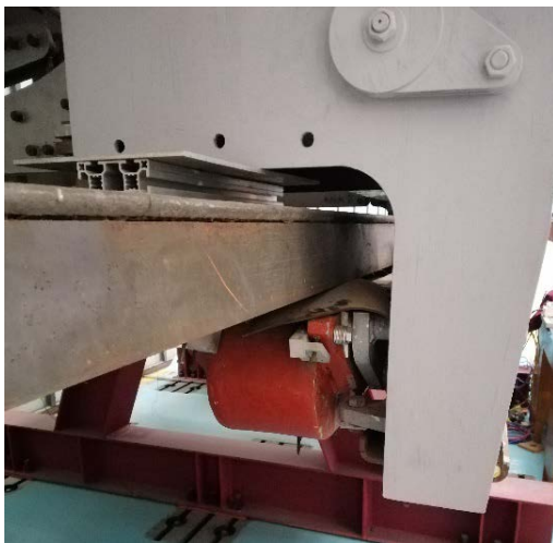
ภาพที่ 7 ผลิตแม่เหล็กไฟฟ้า สำหรับสร้างแรงลอยตัวแม่เหล็ก ของรถไฟแม็กเลฟ
