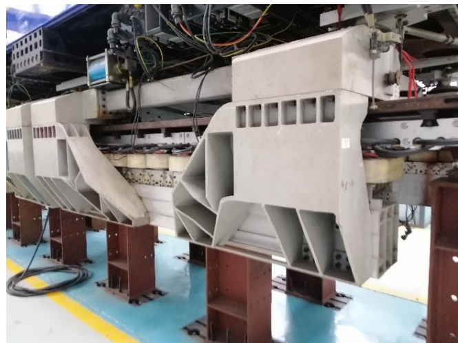
ภาพที่ 8 แคร่และช่วงล่างของรถไฟแม็กเลฟที่ ประกอบด้วยผลิตแม่เหล็กไฟฟ้า และทางวิ่ง ที่ประกอบด้วยผลิตแม่เหล็กไฟฟ้าเช่นกัน ขับเคลื่อนด้วยหลักการมอเตอร์ซิงโครนัสเชิงเส้น
